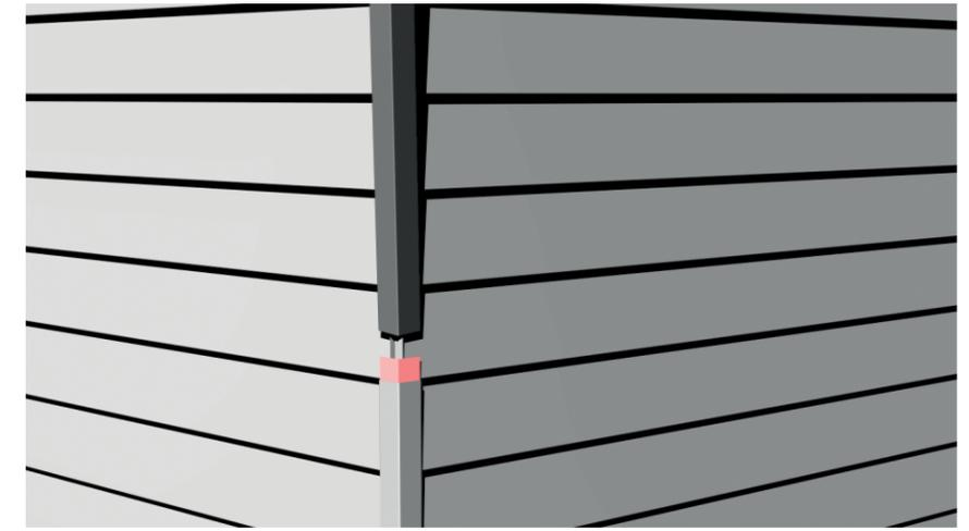
Pour permettre une bonne tenue verticale des pièces d'angle, on fixera la bande d'angle en tête par une vis laquée à tête plate.
