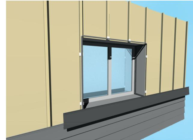
Positionner les panneaux de façade pour tracer les découpes à réaliser autour de l'appui de fenêtre.
